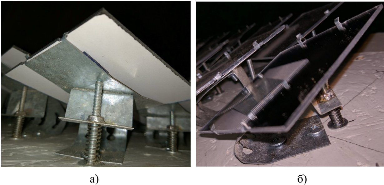
Рис. 5. Дзеркальний елемент фасетного концентратора у регульованому кріпленні з тильної (а) та фронтальної (б) сторони
