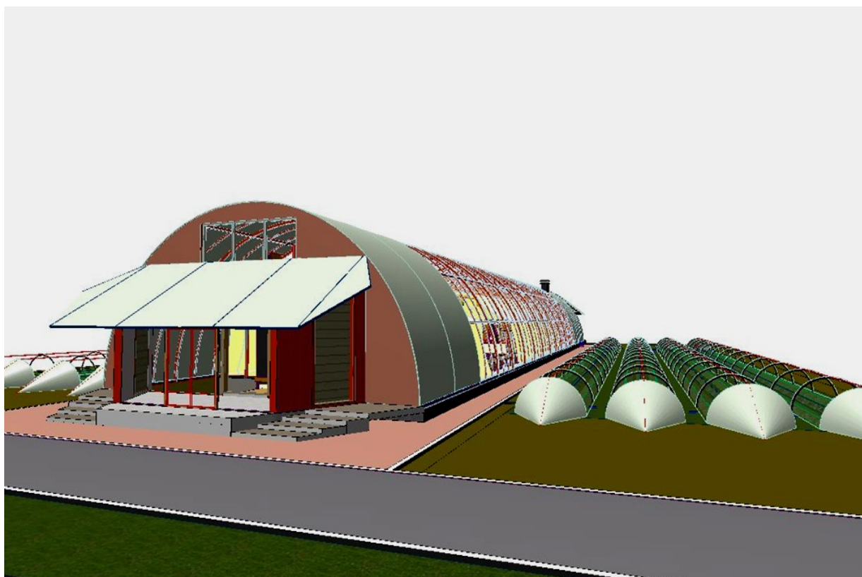
Рис. 24. Загальний вигляд нашої садибної теплиці «ГеліоТермос» Олександра Сременко на горизонтальній поверхні із зовнішнім підігрівним від теплиці ґрунтом
