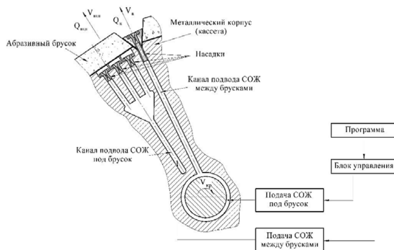
Рис. 2. Подвод СОЖ по каналам шлифовального круга.
