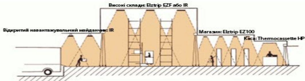
Рис. 1. Схема рівномірного розподілу випромінювання від інфрачервоних обігрівачів
