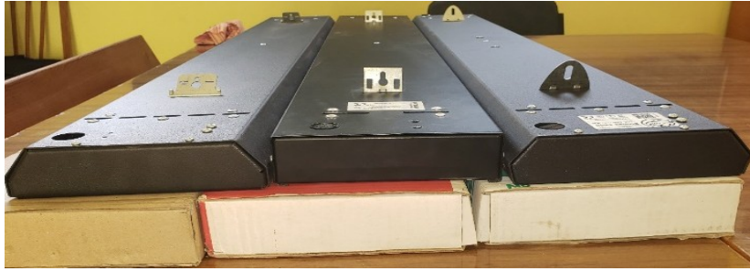
Рис. 2. Профіль поперечного перерізу (Білюкс і Теплотема – усічена трапеція, Теплов – прямокутник)
