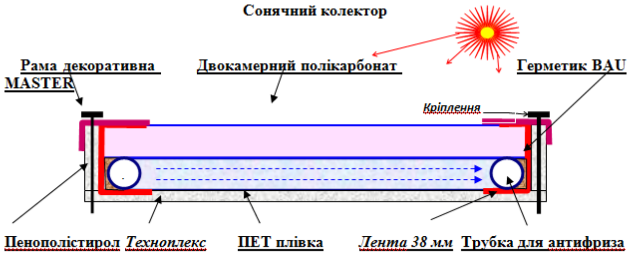
Рис. 16. Сонячний колектор із застосуванням ПЕТ плівки.
