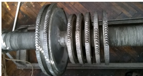
Рис. 6. До визначення витрат пари через лабіринтові ущільнення натурального зразку ротору турбіни
