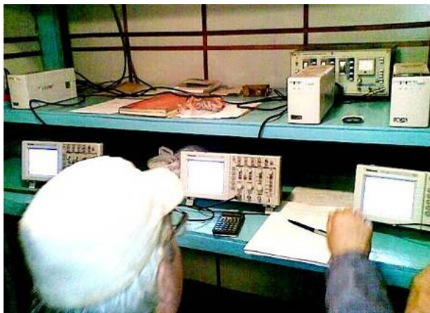
Рис. 5. Внешний вид размещения трех параллельно регистрирующих с одного измерительного шунта типа ШК-300М1 полезные электрические сигналы цифровых запоминающих осциллографов серии Tektronix TDS 1012 в заглубленном экранированном измерительном бункере, предназначенном для метрологического обеспечения натурных испытаний различных технических объектов на молниестойкость [9]
