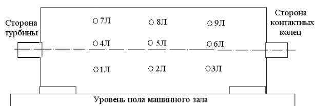
Рис. 1. Расположение точек измерения вибрации со стороны левой части корпуса ТГ (если смотреть со стороны контактных колец)
