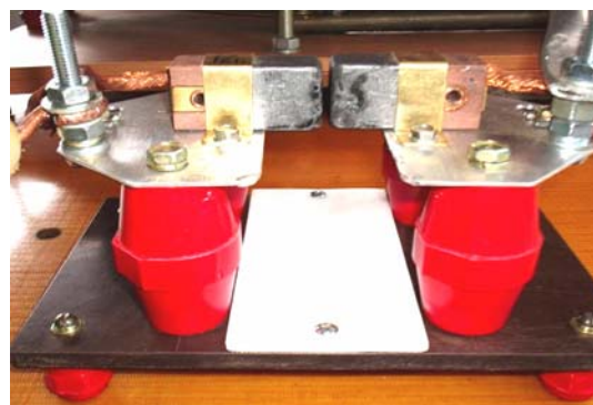
Рис. 3. Внешний вид высоковольтного двухэлектродного воздушного коммутатора типа ВДВК-10 с графитовыми электродами прямоугольной формы на напряжение до \pm 10 кВ, используемого в разрядной цепи генератора ГИТ-С [2]
