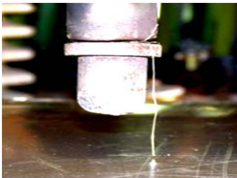
Рис. 5. Укрупненный внешний вид воздушной ДЭС с тонкой медной ЭВП на рабочем столе высоковольтного генератора ГИТ-С с мощным ЕНЭ при испытаниях в его сильноточной разрядной цепи ИО листовой металлической обшивки технического объекта на электротермическую стойкость к прямому воздействию на него длительной С- компоненты тока искусственной молнии с нормированными АВП ( h_a \approx 14 мм; h_e \approx 1 мм; r_e \approx 0,1 мм; l_e \approx 37 мм) [10]
