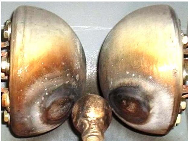
Рис. 2. Укрупненный вид трехэлектродной системы ВСВК каскадного типа с двумя массивными основными полусферическими электродами и одним управляющим сферическим электродом из стали марки Ст.3 на номинальное напряжение \pm 50 кВ и импульсный микросекундный ток амплитудой I_m до \pm 300 кА (вид после однократного воздействия на ее стальные электроды в разрядной цепи ВЭФУ с мощным ЕНЭ импульсного затухающего синусоидального тока частотой \omega/2\pi = 4,9 кГц и первой амплитудой I_{ms} = -202 кА; J_a = 2,12 \cdot 10^6 Дж/Ом; опытное значение радиуса канала искры r_{cm} \approx 31 мм; длина канала искры l_c \approx 13,5 мм)
