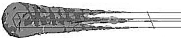
Рис. 1. Напряженный объем E -поля вокруг стержня квадратного сечения (модель повернута на 90^\circ влево)
