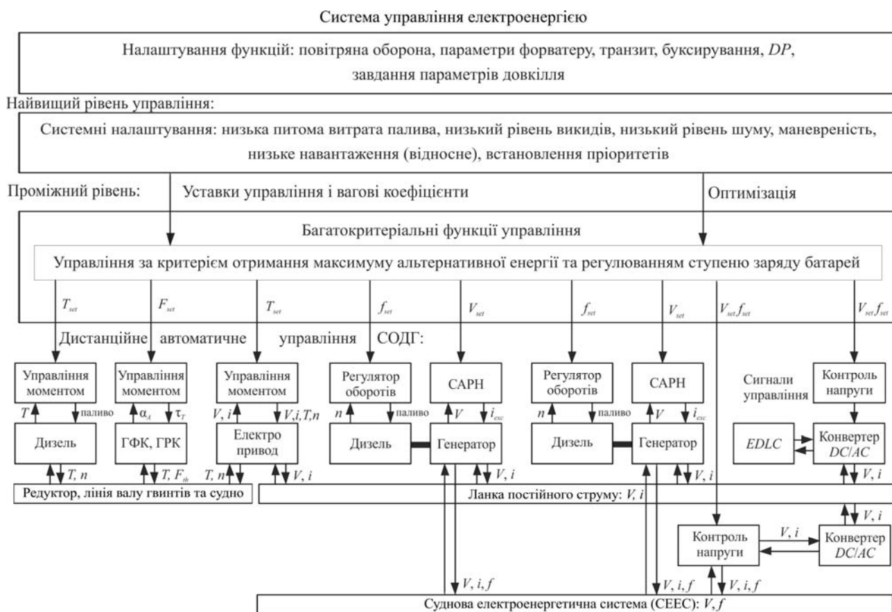
Рис. 8. Блок-схема стратегії управління СЕУ КПК за критерієм максимуму альтернативної енергії та регулювання ступеню заряду батарей СНЕ: CAPN – система автоматичного регулювання напруги; ГРК – гвинт регульованого кроку; ГФК – гвинт фіксованого кроку; X_{\text{set}} – уставка; T – упор (момент); F – сила поштовху гвинта; f – частота напруги; V – напруга; n – частота обертання СОДГ; i_{\text{exc}} – струм збудження генераторів; i – струм; \tau_T – результуюча проекція вектору зусилля на площину руху судна; \alpha_A – кут повороту ПП відносно діаметральної площини судна
