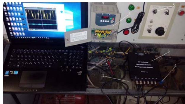
Рис. 7. Зовнішній вигляд лабораторної установки: 1 – частотний перетворювач; 2 – двофазний AD; 3 – осцилограф; 4 – датчик струму; 5 – регулювання струму навантаження
