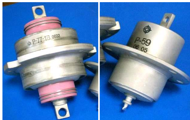
Рис. 7. Внешний вид мощных грозозащитных герметичных разрядников, применяемых при защите радиотехнической аппаратуры от перенапряжений, вызванных прямым ударом в нее молнии (слева-направо: типа Р-77-1В и типа Р-59) [36]
