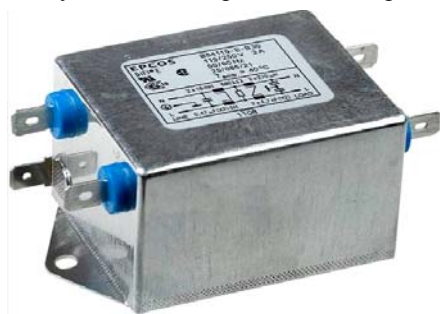
Рис. 19. Общий вид сетевого фильтра подавления МЭМП типа B84115-E-B30 (ток – 6 А; напряжение – 250 В; частота – 50/60 Гц; изготовитель – фирма «Epcos», Германия) [46]
