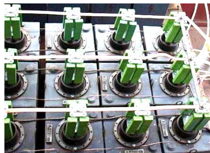
Рис. 25. Внешний вид фрагмента мощного высоковольтного ЕНЭ одномодульного исполнения на номинальное напряжение \pm 50 кВ и номинальную запасаемую электрическую энергию 420 кДж с его параллельно включенными конденсаторами типа ИК-50-3 в количестве 112 шт. и жестко установленными на их всех высоковольтных выводах защитными высоковольтными постоянными графито-керамическими резисторами типа ТВО-60-24 Ом [49]
