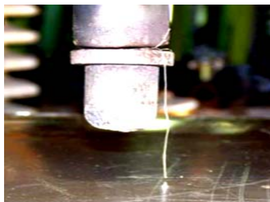
Рис. 4. Общий вид ДЭС с медной ЭВП рабочего стола генераторов ГИТ-А и ГИТ-С при испытаниях в их разрядных цепях ИО тонкой стальной кровли на электротермическую стойкость к прямому воздействию на них импульсной A - и длительной C - компонент тока искусственной молнии с нормированными согласно [3, 4] АВП ( l_e = 37-50 мм) [8]
