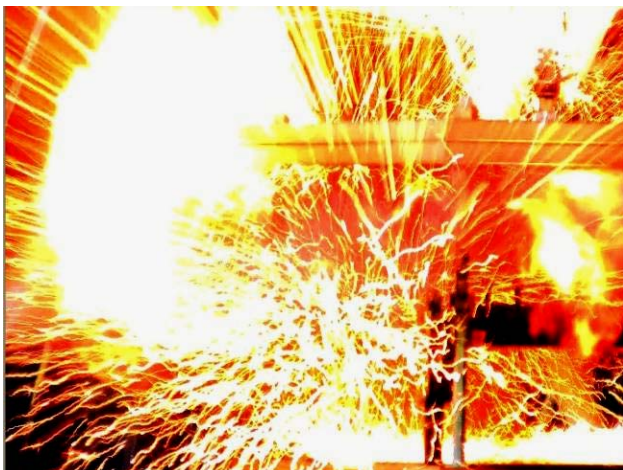
Рис. 5. Начальная стадия ЭВ медной жилы сечением S_1 \approx 3,2 \text{ мм}^2 ОО радиочастотного коаксиального кабеля марки РК 50-7-11 со сплошной ПЭТ изоляцией длиной 0,5 м в сильноточной разрядной цепи генератора типа ГИТМ-10/350
