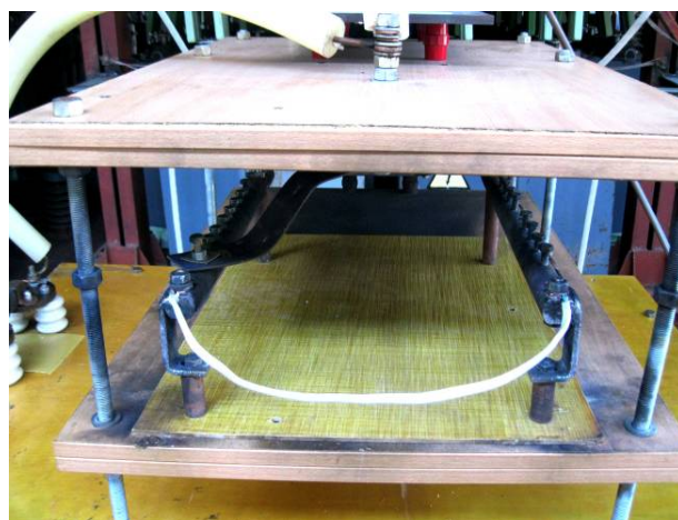
Рис. 8. Внешний вид рабочего стола генератора типа ГИТМ-10/350 с жестко закрепленными на его массивных стальных электродах сплошными круглыми медными жилами общим сечением S_1 \approx 5 \text{ мм}^2 ОО провода марки ПНП 2×2,5 с ПВХ изоляцией длиной 0,5 м до воздействия на них аperiodического импульса тока 15/335 мкс искусственной молнии амплитудой около I_{mL} \approx 85,6 \text{ кА} ( U_{31-3} \approx 16,5 \text{ кВ} ; U_{34} \approx 4,2 \text{ кВ} )
