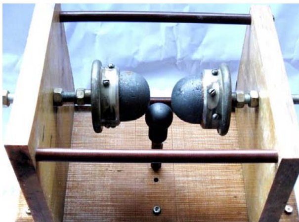
Рис. 1. Общий вид сверху высоковольтного трехэлектродного воздушного коммутатора с графитовыми основными и управляющим электродами типа КВТГ-50 на номинальное напряжение \pm 50 кВ и импульсный ток амплитудой до \pm 220 кА микросекундного временного диапазона
