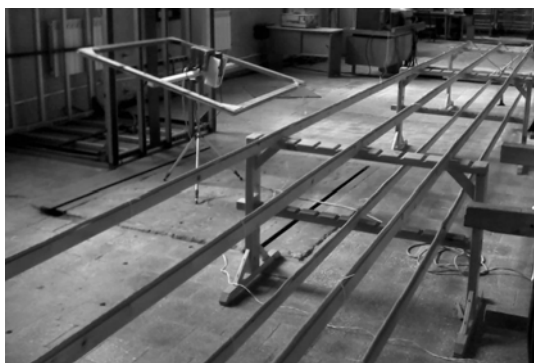
Рис. 1. Внешний вид макета обмотки магнитного исполнительного органа и трехфазного токопровода
