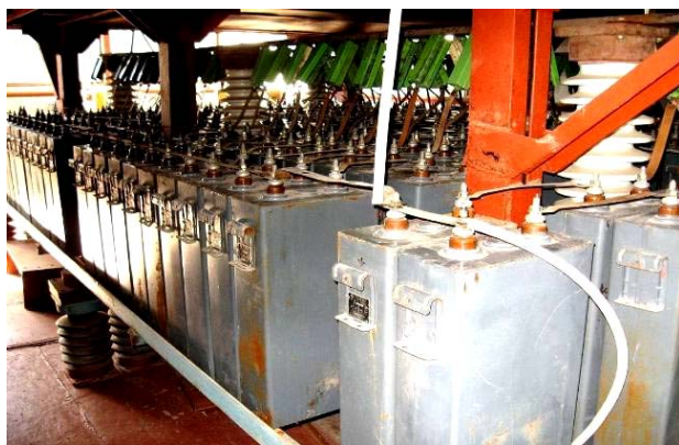
Рис. 5. Общий вид генератора ГИТ-4 (288 последовательно-параллельно включенных конденсаторов типа ИМ2-5-140 на 1 и 2 этажах НМК) на номинальное напряжение \pm 10 кВ, входящего в состав мощного генератора ГИТМ-10/350
