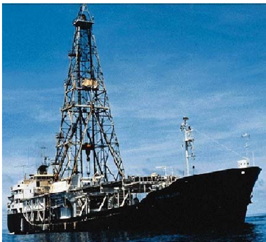
Рис. 4. Первое океанологическое судно "Гломар Челленджер", проводившее бурение дна океана на глубину до 1000 м (при толще морской воды над ним до 6000 м) [10]
