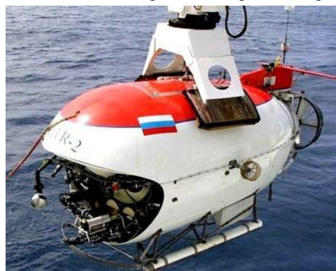
Рис. 9. Внешний вид российского глубоководного обитаемого аппарата нового поколения "Мир-2" (2000 год) [1, 7]
