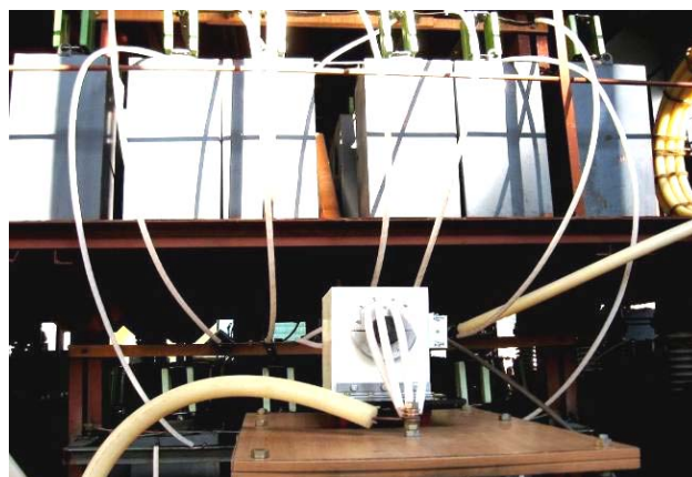
Рис. 3. Общий вид генераторов ГИТ-1 (16 параллельно соединенных конденсаторов типа ИК-50-3 на 1 и 2 этажах НМК) и ГИТ-2 (44 параллельно соединенных конденсаторов типа ИК-50-3 на 1 и 2 этажах НМК) на номинальное зарядное напряжение \pm 50 кВ, входящих в состав мощного высоковольтного генератора ГИТМ-10/350
