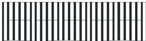
Рис. 6. Участок соединения ярма (вверху) и стержней (внизу)
