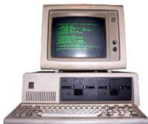
Рис. 15. Американский стационарный персональный компьютер IBM PC 5150 (1981 год), ставший основой для всех современных настольных микрокомпьютеров [11]
