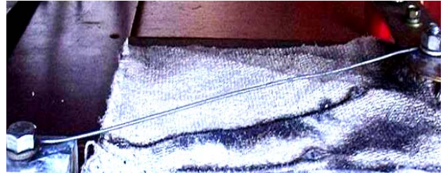
Рис. 2. Общий вид круглого прямолинейного оцинкованного стального проводника ( r_0=0,8 мм; l_0=320 мм; \Delta_0=5 мкм; S_0=2,01 мм 2 ), размещенного в воздухе над теплозащитным асбестовым полотном, до протекания по нему в разрядной цепи мощного высоковольтного генератора ГИТ-5С униполярного импульса аксиального тока большой плотности
