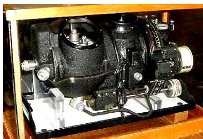
Рис. 23. Музейная модель серийно выпускавшегося аналогового бомбового прицела "Norden" (США, 1944 год) [15]
