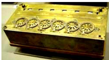
Рис. 3. Суммирующая механическая машина Б. Паскаля [3]
