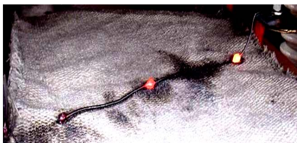
Рис. 4. Опытное распределение вдоль оцинкованного стального проводника ( r_0=0,8 мм; l_0=320 мм; \Delta_0=5 мкм; S_0=2,01 мм 2 ) остывающих на воздухе и теплозащитном асбестовом полотне трех "горячих" (высокотемпературных зон ВЭП проводника шириной \Delta z_{nc}=7 мм) и трех "холодных" (одного крайнего шириной \Delta z_{nxc}=50 мм и двух внутренних шириной \Delta z_{nxc}=100 мм) продольных участков после протекания по нему импульса аксиального тока i_0(t) временной формы 9 мс/576 мс большой плотности ( I_{0m}=-745 А; |\delta_{0m}|=0,37 кА/мм 2 ; n=3 ; второй левый крайний "холодный" продольный участок проводника подвергся полной сублимации)
