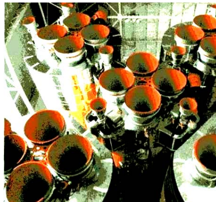
Рис. 12. Блок мощных ракетных двигателей первой ступени носителя космического корабля "Союз-ТМ", находящихся в монтажно-испытательном корпусе космодрома "Байконур"
