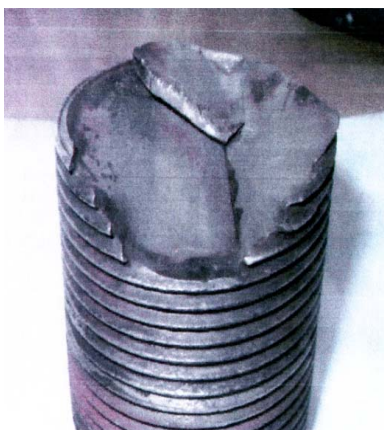
Рис. 1. Усталостный излом хвостовика стяжной призмы по резьбе М64х4 турбогенератора ТВВ 1000-2УЗ
