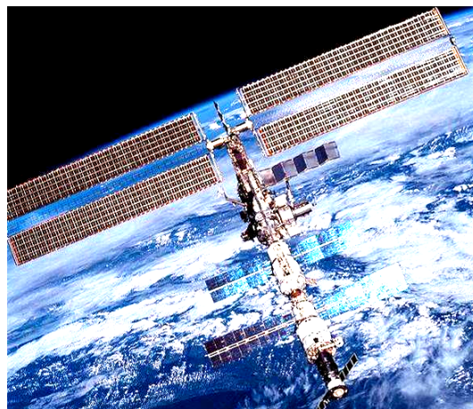
Рис. 32. Солнечные батареи станции "МКС" в 2001 году (видны российские батареи модулей "Заря" и "Звезда" и ферменная конструкция с американскими батареями) [17]
