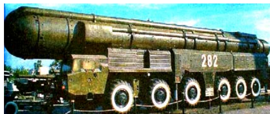
Рис. 19. Советский мобильный ракетный комплекс с твердотопливной ракетой средней дальности SS-20, характеризующийся весом 37 т и дальностью стрельбы до 5000 км [1]
