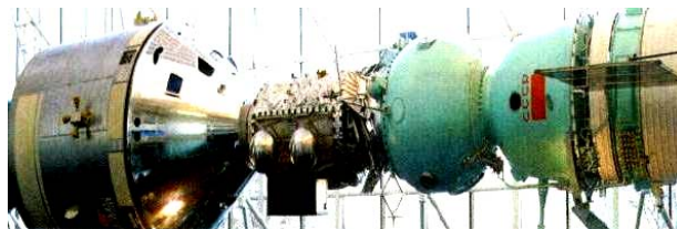
Рис. 30. Музейные экспонаты совместного полета в 1975 году на околоземной орбите американского космического аппарата "Аполлон" (слева) и советского космического корабля "Союз-19" (между этими кораблями разместился специально разработанный для этого переходной отсек) [1]
