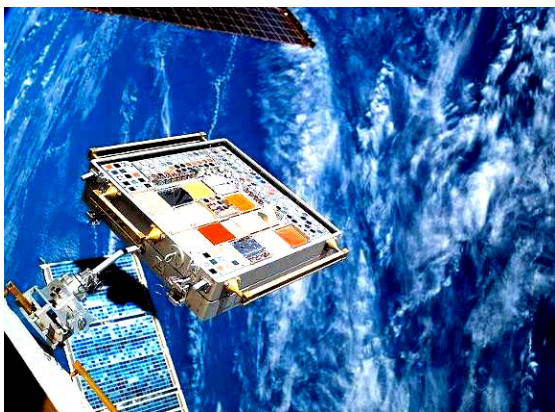
Рис. 34. Опытные образцы из различных материалов, исследуемые за бортом "МКС" на отдельных панелях в открытом космосе (этот снимок был сделан 13 августа 2007 года) [17]
