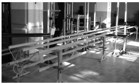
Рис. 1. Внешний вид макета трехфазного токопровода
