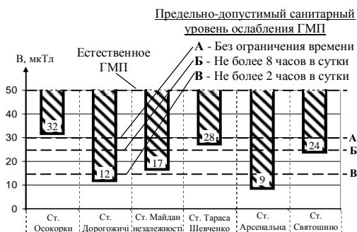
Рис. 7. Результаты экспериментальных исследований индукции ГМП на платформах подземных станций Киевского метрополитена
