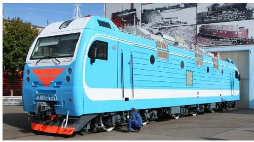
Рис. 9. Общий вид серийно выпускаемого в 21-ом столетии отечественного электровоза типа ЭП1М для перевозки по железной дороге крупнотоннажных грузов [1]
