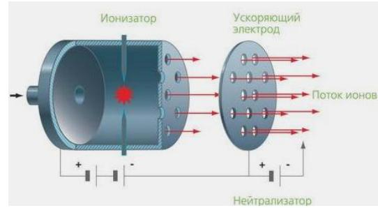
Рис. 32. Упрощенная схема построения и работы ИД [28]
