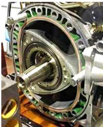
Рис. 16. Внешний вид роторно-поршневого двигателя Ванкеля с разобранным овальным цилиндром этого ДВС [15]
