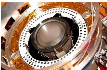
Рис. 34. Внешний вид современного американского ионного ракетного двигателя типа NSTAR, установленного в 1998 году NASA на космический зонд Deep Space 1 (США) [28]
