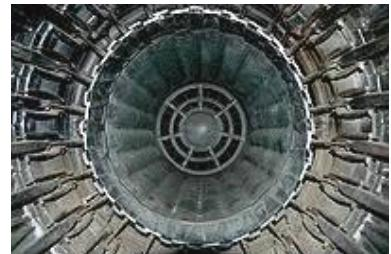
Рис. 21. Форсажная камера американского турбореактивного двигателя типа GEJ79 (вид со стороны сопла двигателя) производства компании "General Electric" (США) [23]
