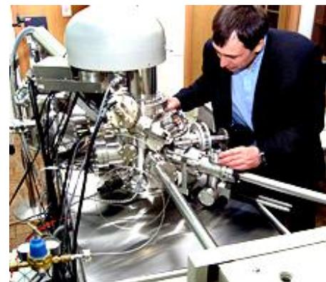
Рис. 1. Внешний вид элементов сканирующего зондового микроскопа Института металлофизики НАН Украины для комплексного исследования nanoобъектов [8]
