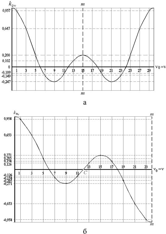
Рис. 1. Типичные зависимости  $k_{Dv}=f(v_0)$  для обмоток с нечетными (а,  $q=5$ ) и четными (б,  $q=4$ ) значениями  $Q=q$
