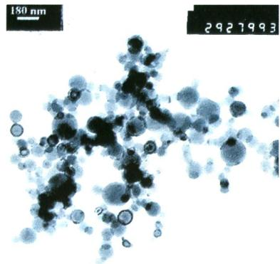
Рис. 4. Внешний вид представителей наноматериалов 1-го рода – ультрадисперсных наночастиц алюминия Al, полученный на СЗМ (слева вверху дан масштаб – 180 нм) [4]
