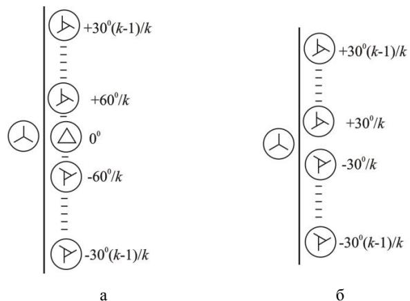
Рис. 3. Обобщенная схема многообмоточного трансформатора: а – при нечетном количестве ячеек в фазе инвертора; б – при четном количестве ячеек в фазе инвертора
