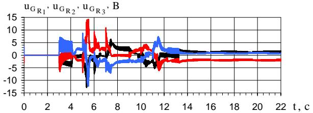
Рис. 4.  $u_{G_{R_1}}, u_{G_{R_2}}, u_{G_{R_3}}$  – фазні напруги ротора АГ
