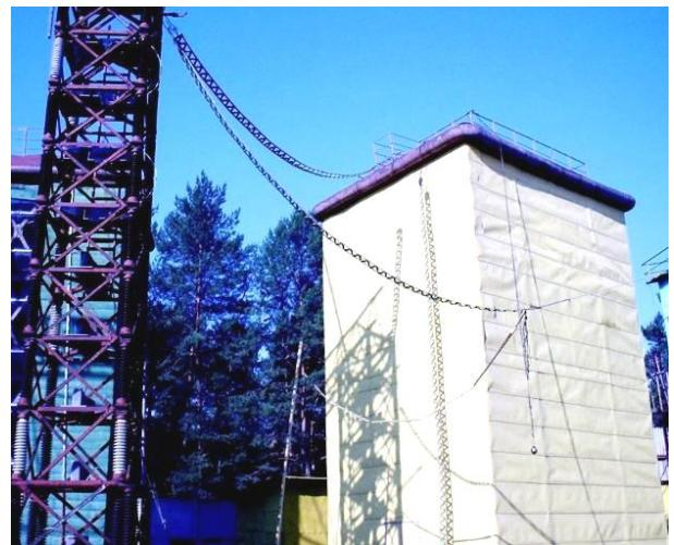
Рис. 4. Общий вид генератора для формирования активно-индуктивной нагрузки стандартного коммутационного апериодического импульса напряжения временной формы 205/1900 мкс амплитудой  $U_m$  до 2 МВ (слева видна изоляционная опора с нагрузочной емкостью  $C_H \approx 13,3$  нФ, к верхнему потенциальному электроду которой подсоединенены формирующий  $R_\phi \approx 4,28$  кОм и токоограничивающий  $R_T \approx 4,59$  кОм резисторы)
