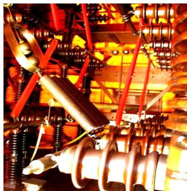
Рис. 3. Общий вид основных элементов модернизированного зарядно-разрядного контура (ЗРК) генератора ГИН-4, содержащего в зарядных цепях положительной и отрицательной полярностей своих высоковольтных каскадов 32 штуки высокоомных резисторов  $R_3 \approx 30$  кОм
