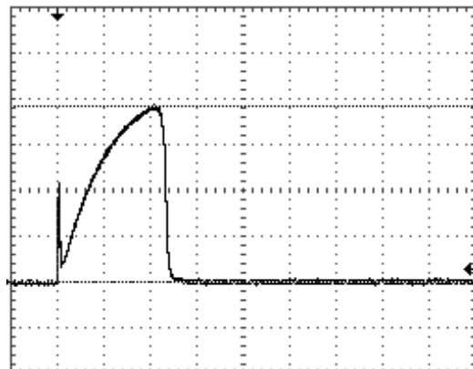
Рис. 10. Осциллограмма срезанного коммутационного апериодического импульса напряжения положительной полярности при электрическом пробое воздушного промежутка длиной 3 м в двухэлектродной системе "игла-плоскость" ( $U_3 \approx \pm 60$  кВ;  $U_c \approx 1030$  кВ;  $T_c \approx 110$  мкс; масштаб по вертикали - 268 кВ/клетка; масштаб по горизонтали - 50 мкс/клетка)
