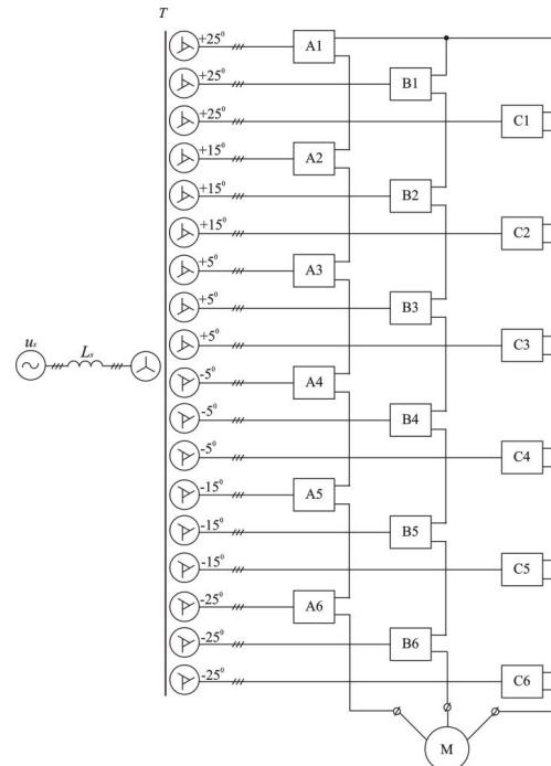
Рис. 1. Структурная силовая схема электропривода на основе МУИПЧ
