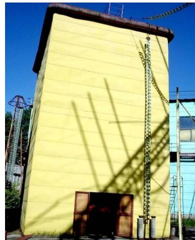
Рис. 1. Общий вид генератора импульсных напряжений ГИН-4 на номинальное напряжение 4 МВ и номинальную запасаемую электрическую энергию 1 МДж, входящего в состав созданного ГКИН на напряжение  $U_m$  до 2 МВ [4, 5]
