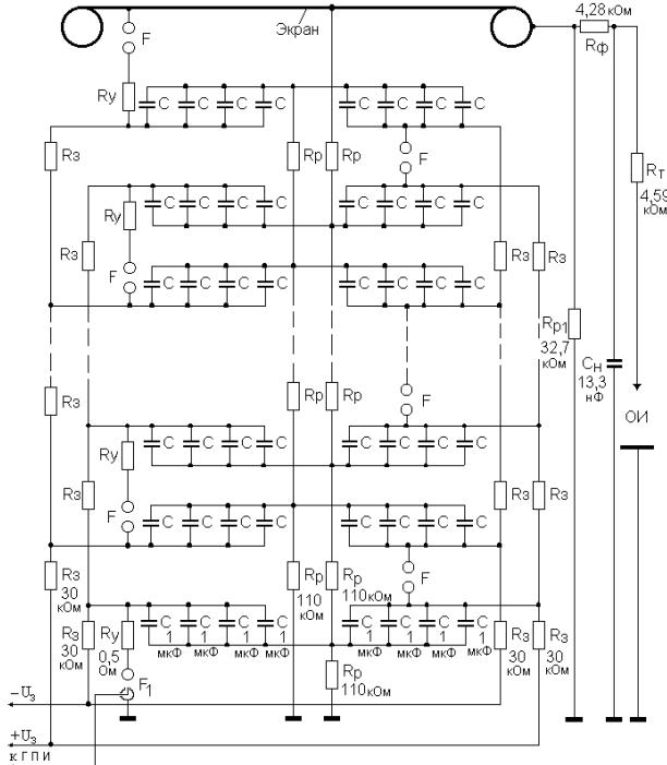
Рис. 2. Электрическая схема замещения модернизированного генератора импульсных напряжений ГИН-4, подсоединеного в схеме формирования стандартных коммутационных апериодических импульсов напряжения к дополнительному разрядному  $R_{p1} \approx 32,7$  кОм, формирующему  $R_\phi \approx 4,28$  кОм и токоограничивающему  $R_T \approx 4,59$  кОм резисторам, нагрузочной емкости  $C_H \approx 13,3$  нФ и ОИ – двухэлектродной системе "игла-плоскость" с длинным воздушным разрядным промежутком
