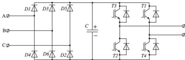
Рис. 2. Схема силовых цепей инверторной ячейки
