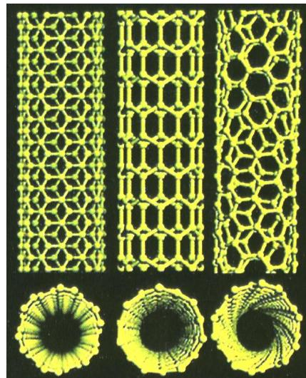
Рис. 5. Модели идеальных углеродных нанотрубок диаметром около 1 нм и длиной до 1 мм различной хиральности (вверху – вид сбоку, а внизу – вид с торца), открывших в науке и технике новый класс nanoструктурных материалов – наноматериалов 2-го рода [4]
