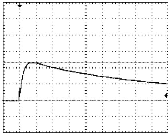
Рис. 8. Осциллограмма полного коммутационного апериодического импульса напряжения положительной полярности на двухэлектродной системе "игла-плоскость" с длиной воздушного промежутка в 3 м ( $U_3 \approx \pm 32$  кВ;  $U_m \approx 622$  кВ;  $T_{II} \approx 205$  мкс;  $\tau_{II} \approx 1900$  мкс; масштаб по вертикали - 268 кВ/клетка; масштаб по горизонтали - 250 мкс/клетка)
