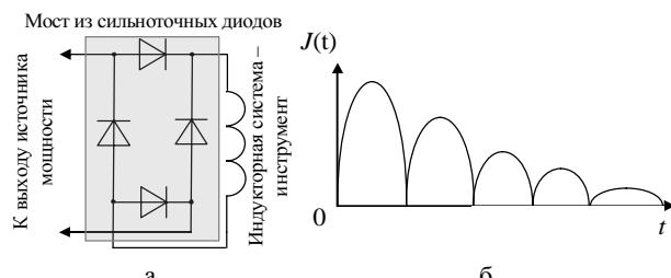
Рис. 2. Формирование униполярного импульса в разрядной цепи с помощью выпрямительного моста, а) схема подключения, б) временная форма генерируемого тока
