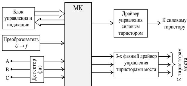
Рис. 4. Структурная схема системы контроля и управления МИУ
