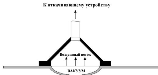
Рис. 3. Схема производственной операции по вакуумному устранению вмятин с поверхности листовых металлов
