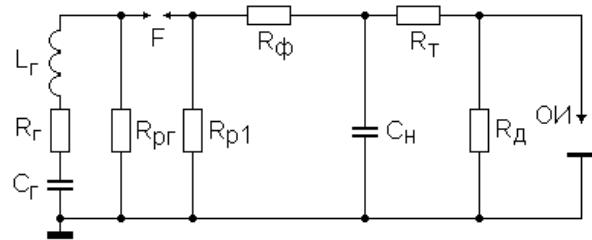
Рис. 5. Принципиальная электрическая схема замещения разрядной цепи ГКИН, формирующую на ОИ – длинном разрядном воздушном промежутке двухэлектродной системы "игла-плоскость" стандартный коммутационный апериодический импульс высокого и сверхвысокого напряжения обеих электрических полярностей временной формы  $T_p/\tau_I \approx 205/1900$  мкс амплитудой  $U_m$  до 2 МВ
