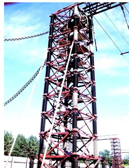
Рис. 6. Общий вид созданной и установленной на существующей изоляционной опоре нагрузочной емкости  $C_H \approx 13,3$  нФ на номинальное импульсное напряжение 3 МВ, примененной в разрядной цепи описываемого ГКИН
