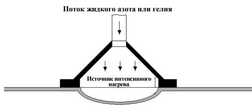
Рис. 4. Схема производственной операции по устранению вмятин с помощью её интенсивного нагрева и последующего резкого охлаждения
