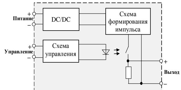
Рис. 5. Структурная схема драйвера управления тиристором
