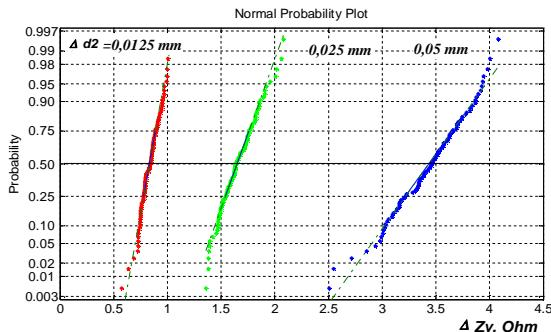
Рис. 7. Вплив варіацій діаметру по ізоляції  $\pm \Delta(d_I)$  на відхилення хвильового опору
