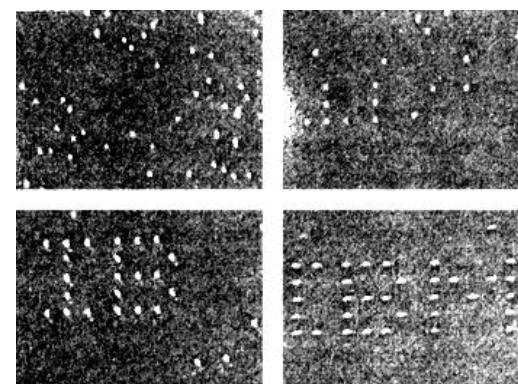
Рис. 2. Надпись "IBM" на грани (110) монокристалла никеля Ni из отдельных 35 атомов ксенона Xe, последовательно реализованная нанотехнологом при помощи зонда СЗМ [2]
