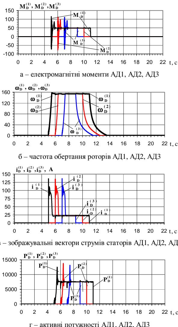
Рис. 6. Розрахункові залежності основних електромеханічних координат асинхронних двигунів
