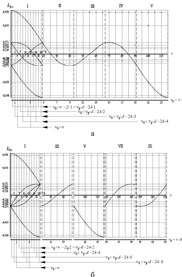
Рис. 3. Зависимости  $k_{Dv} = f(v_p)$  и  $k_{Dv} = f(v_0)$  основной дробной обмотки ( $q=4/5$ )
