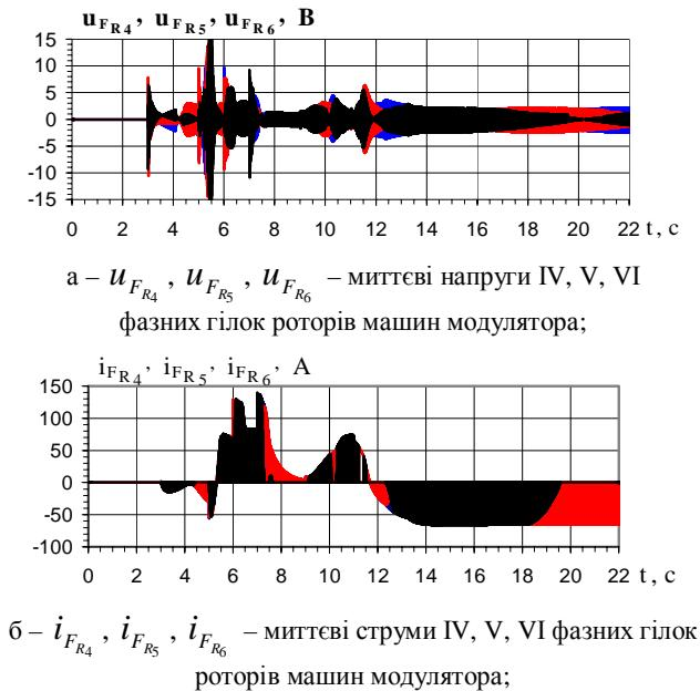
Рис. 3. Розрахункові залежності миттєвих значень напруг та струмів IV, V, VI фазних гілок роторів машин модулятора
