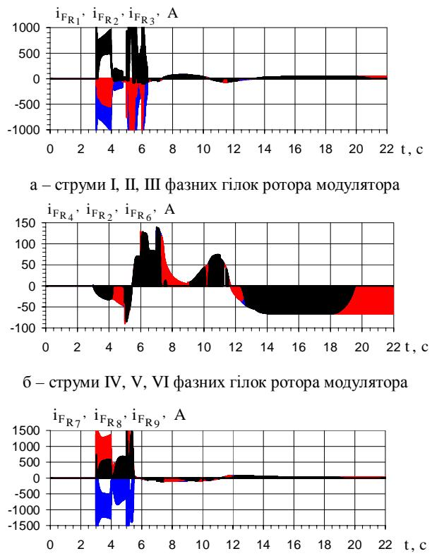
в – струми VII, VIII, IX фазних гілок ротора модулятора
