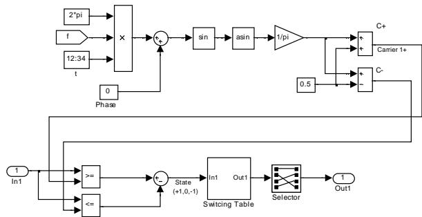
Рис. 9. Модель ШИМ-генератора для транзисторов первой ячейки
