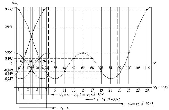
Рис. 2. Зависимости  $k_{Dv}=(v_p)$  и  $k_{Dv}=f(v_0)$  основной дробной обмотки ( $q=5/4$ )
