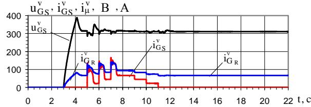
Рис. 2.  $u_{Gs}^v$ ,  $i_{Gs}^v$ ,  $i_\mu^v$  модулі зображення векторів фазних напруг і струмів статора та фазних струмів ротора генератора
