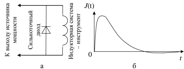
Рис. 3. Формирование униполярного импульса в разрядной цепи с помощью выпрямительного моста, а) схема подключения, б) временная форма генерируемого тока
