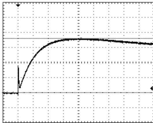
Рис. 9. Осциллограмма нарастающей части полного коммутационного апериодического импульса напряжения положительной полярности на двухэлектродной системе "игла-плоскость" с длиной воздушного промежутка 3 м ( $U_3 \approx \pm 51$  кВ;  $U_m \approx 966$  кВ;  $T_{II} \approx 205$  мкс; масштаб по вертикали - 268 кВ/клетка; масштаб по горизонтали - 50 мкс/клетка)
