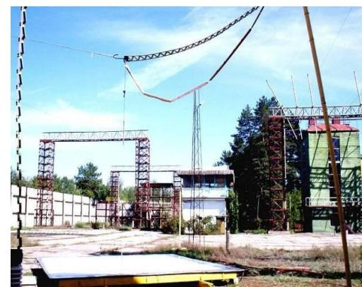
Рис. 7. Общий вид делителя ОДН-2 на номинальное напряжение 2,5 МВ, подсоединеного в разрядной цепи ГКИН к двухэлектродной системе "игла-плоскость"
