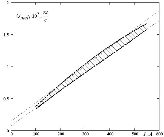
Рис. 4. Область изменения скорости расплавления  $G_{melt}$  при учете испарения с поверхности капли и отсутствии подогрева электрода (прямая полярность)
