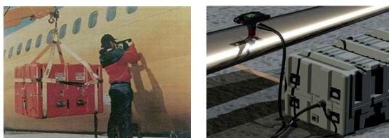
Рис. 2 Системы магнитно-импульсного устранения вмятин в элементах летательных аппаратов: а – разработка фирмы "Electroimpact"; б – оборудование, предлагаемое компанией "Fluxtronic"
