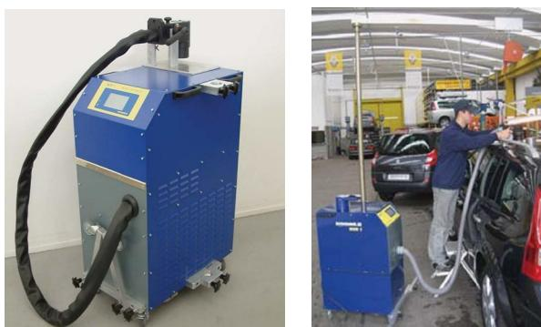
Рис. 6. Магнитное приспособление для удаления вмятин концерна "Beulentechnik AG": а – источник мощности с инструментом; б – приспособление в действии
