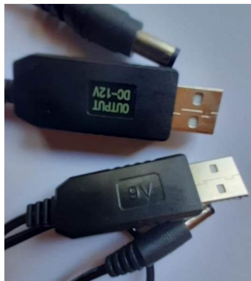
Рис.9. Кабелі-перехідники з вбудованими модулями підвищення напруги до 9 та 12 В
