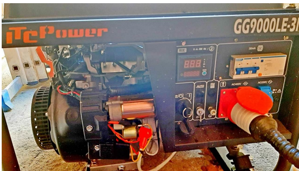
Рис. 6. Бензиновий генератор автономного електроживлення потужністю 6 кВт
