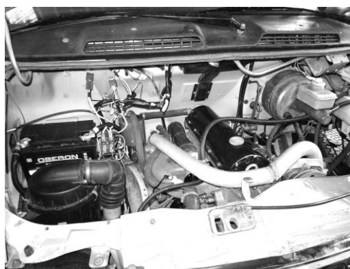
Рис. 1. Моторний відсік дослідного автомобіля МА33 з дизелем 4ДТНА1
