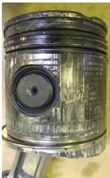
Рис.3. Приклад втрати параметричної надійності поршня двотактного дизеля
