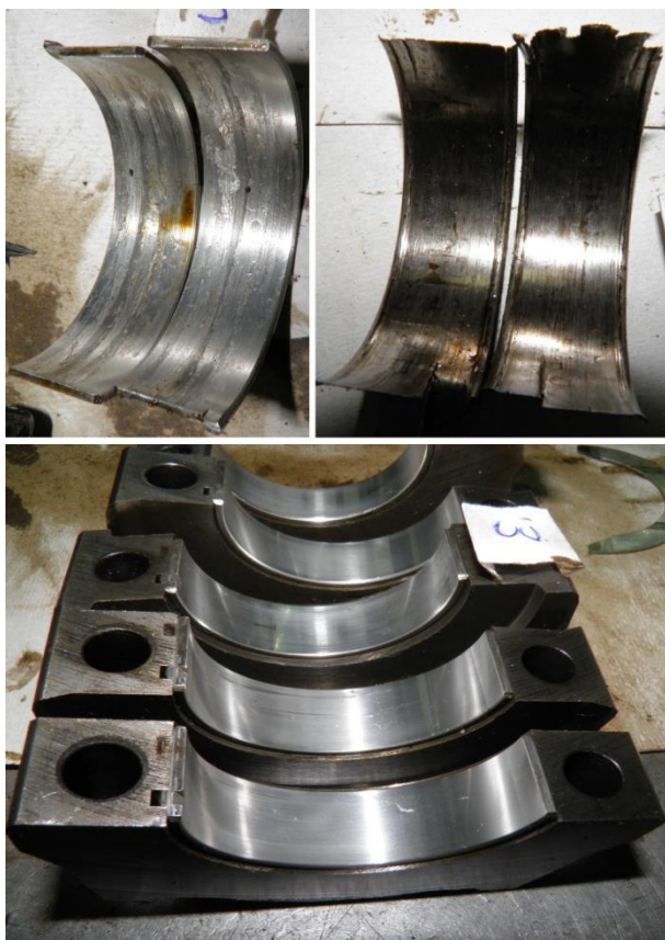
Рис.1. Типичный пример повреждения шатунных подшипников (вверху) при отсутствии заметных повреждений коренных подшипников (внизу) - обычный результат эксплуатации двигателя с недостаточным уровнем масла
