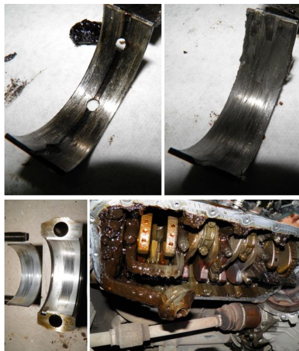
Рис.2. Противоположный случай - повреждения коренных подшипников с плавлением, заклиниванием вала и проворачиванием вкладышей в постелях (вверху), сопровождаемые сравнительно небольшими повреждениями шатунных подшипников (внизу), вызван чрезвычайно быстрой деградацией моторного масла с закупориванием сетки маслоприемника
