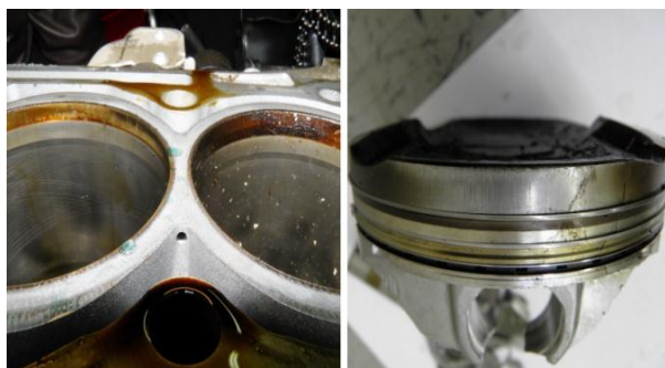
Рис.3. Главный признак гидроудара – расширение пояса нагара в верхней части цилиндра (слева), и один из подтверждающих признаков – стертый нагар над отверстием поршневого пальца (справа), свидетельствующие о деформации (изгибе и укорочении) шатуна и работе поршня с перекосом и недоходом до ВМТ в цилиндре
