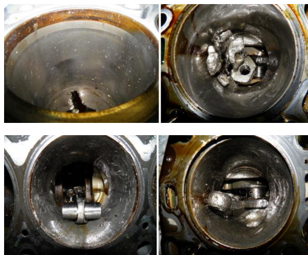
Рис.1. Типичные последствия тяжелых повреждений ДВС, в том числе, при гидроударе, масляном голодании (вверху), разрушении клапана и поршневого пальца (внизу)
