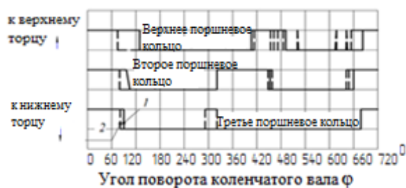
Рис. 1. Положение верхнего, второго и третьего колец относительно торцевых поверхностей канавок в зависимости от угла поворота коленчатого вала \varphi :
