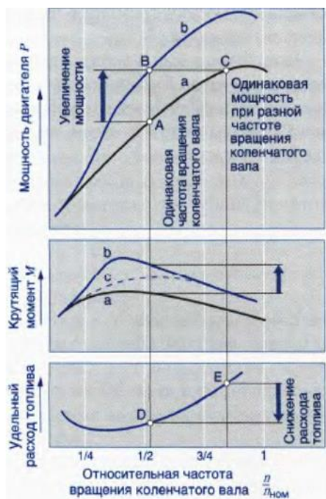
Рис. 6. Графік протікання кривих потужностей і крутного моменту дизеля з турбонадувом та без, де a- дизель без наддуву в стаціонарному режимі, b- дизель з наддувом в стаціонарному режимі, c-дизель з наддувом в нестационарних режимах
