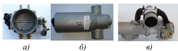
Рис. 3. Підсистема наповнення циліндрів зарядом робочої суміші: а – дросельна заслінка; б – регулятор холостого ходу; в – впускний колектор ДВЗ із підсистемою наповнення циліндрів
