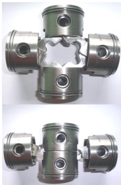
Рис. 2. Рухомий чотирикутник у зборі з поршнями механізму руху роторно-поршневого пневмодвигуна
