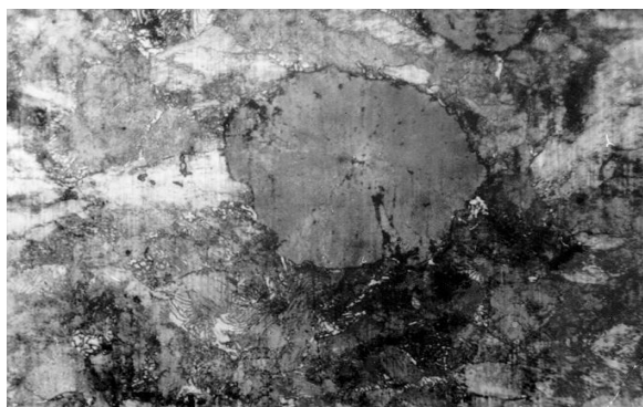
Рис. 2. Микроструктура высокопрочного чугуна ВЧ50-1,5 для поршневых колец дизелей ЧН 25/34, х 600
