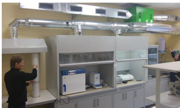
Рис. 3. Установка для досліджень аеродинамічних процесів в трубах КУ і ТД
