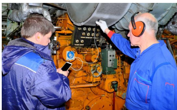
Фото 7. Запись вибрации газотурбонагнетателя
