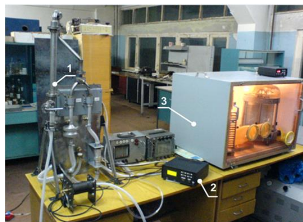
Рис. 1. Основні елементи мікротунелю МКТ-2: 1 – пробовідбірний пристрій; 2 – електронний модуль керування; 3 – камера для зважування фільтрів
