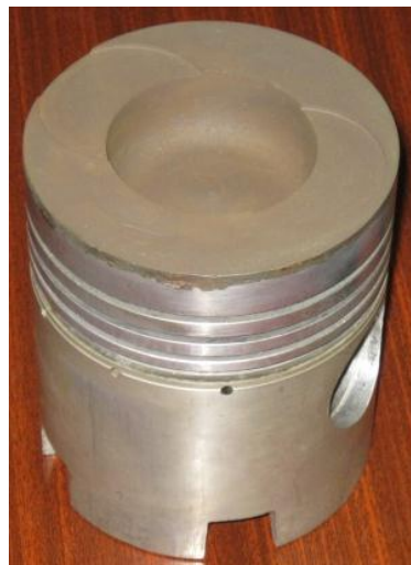
Рис. 1. Поршень з каталітичним покриттям на основі оксиду марганцю
