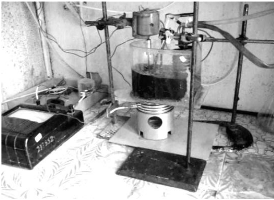
Рис. 1. Установка по нанесенню каталітичного покриття методом ПЕО
