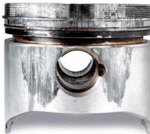
Рис. 2. Специфичный вид задир поршня [1]
