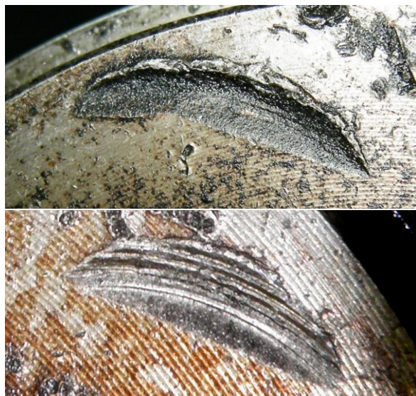
Рис.4. Выемка от ударов головки клапана на поршне при длительном воздействии (вверху) - в отличие от кратковременного при превышении допустимой частоты вращения (внизу)
