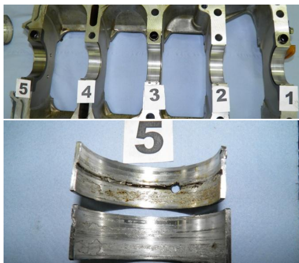
Рис. 7. Пример конструктивно-производственного дефекта коренных подшипников коленвала, который привел к проворачиванию вкладыша и выходу ДВС из строя
