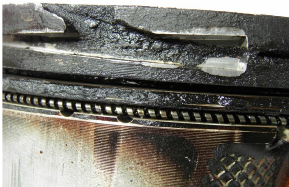
Рис.8. Чрезвычайно сильное "размывание" верхней канавки поршня при длительной работе со сломанным кольцом
