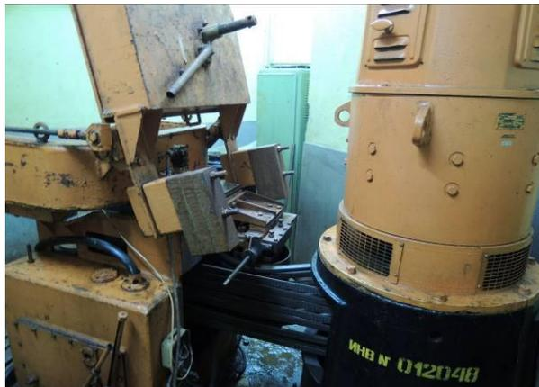
Рис. 1. Общий вид стенда для разгонных испытаний
