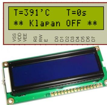
Рис.5. Жидкокристаллический индикатор
