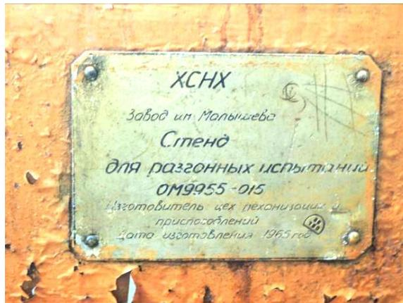
Рис. 2. Фирменная табличка стенда для разгонных испытаний
