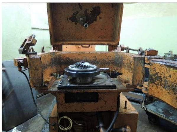
Рис. 3. Стенд для разгона крыльчатки компрессора дизеля 6ТД-2Е
