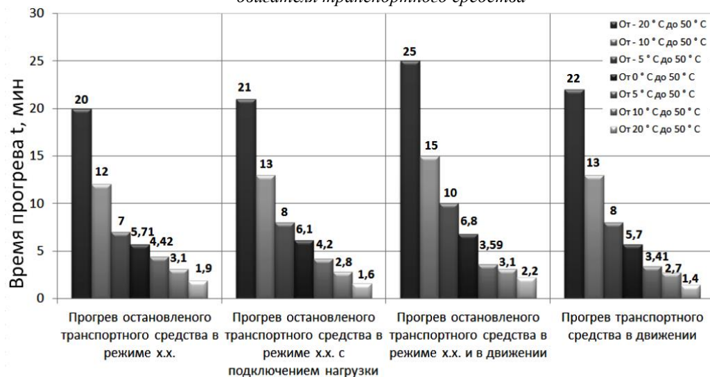
Рис. 5. Результати зміни часу теплової підготовки двигателя транспортного средства до +55 °С, від змінюваної температури оточуючої середовища в залежності від виду (варіанта) теплової підготовки
