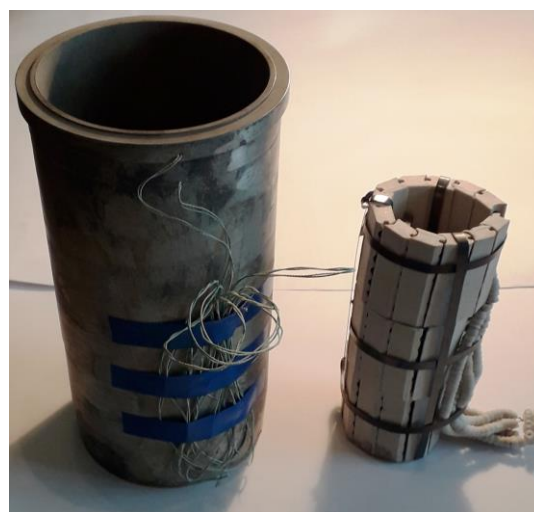
Рис.2. Дослідна гільза з нагрівальним елементом
