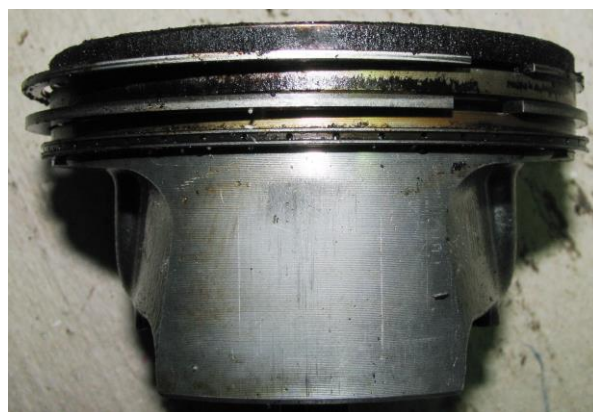
Рис. 1. Результат неудачной модернизации двигателя - из-за деформации цилиндра поршень после сравнительно небольшой наработки уже настолько сильно изношен, что практически выработал свой ресурс
