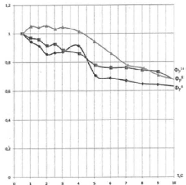
Рис. 5. Управляючі функції \Phi_p для режимів скидання навантаження
