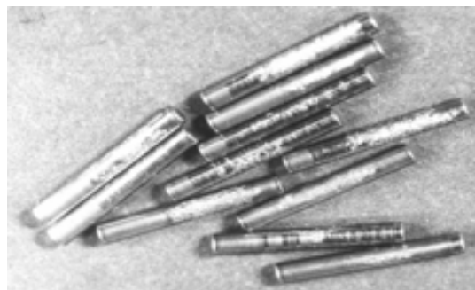
Рис. 4. Игольчатые ролики с началом разрушения
