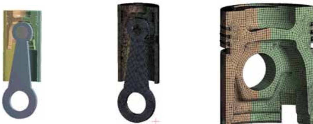
Полная геометрическая модель Конечно-элементная модель Конечно-элементная модель поршня Рис. 4. Внешний вид геометрической и конечно-элементной моделей
