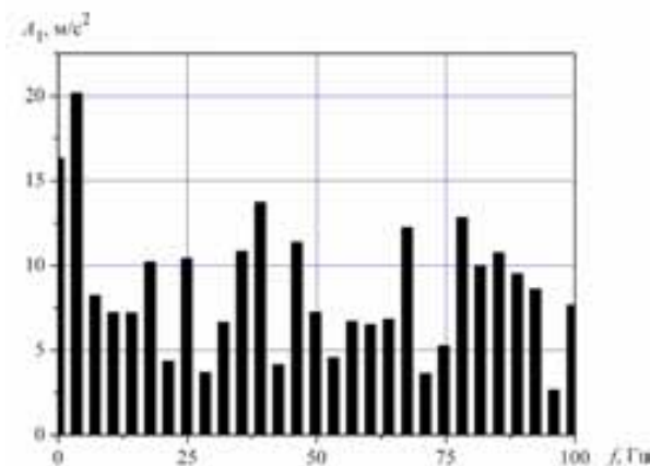
Рис. 5. Амплитудно-частотная характеристика ускорений a опорной точки 1
