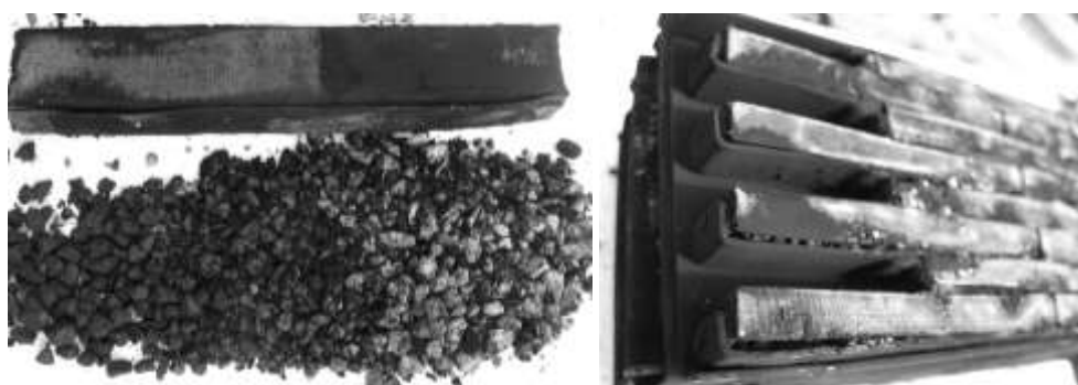
Рис. 5. ДМЦ ФЭ, сетчатая кассета и насыпной цеолит после моторных испытаний
