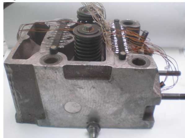
Рис.2. Опытная ГЦ дизеля КамАЗ
