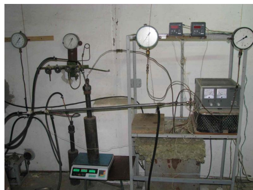
Рис. 1. Експериментальний стенд для отримання синтез-газу
