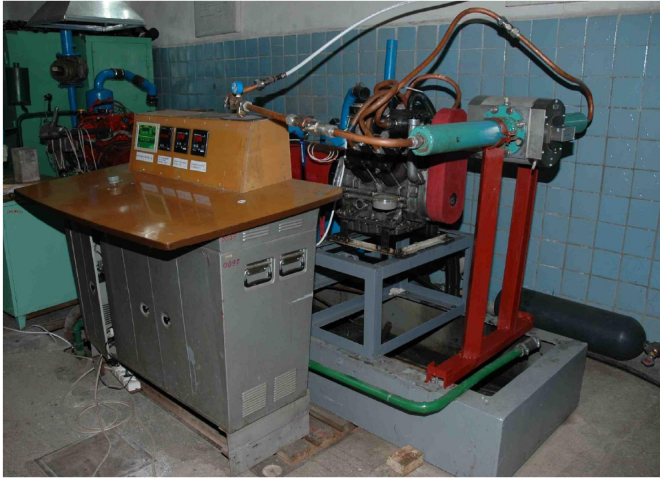
Рис. 2. Загальний вигляд стенда для дослідження пневмодвигунів
