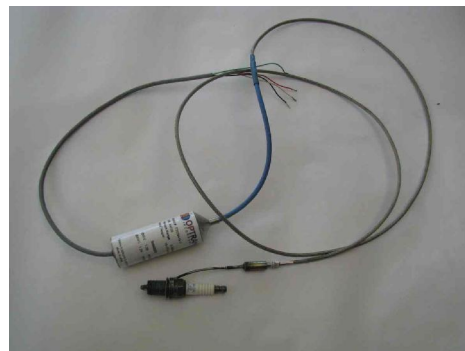
Рис. 5. Свічка запалювання з датчиком тиску OPTRAND
