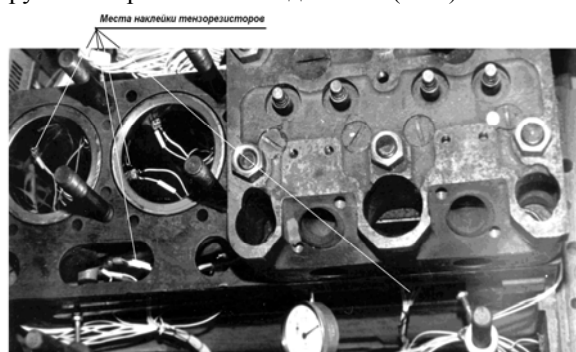
Рис. 2 Общий вид размещения тензорезисторов в ГРС дизеля 4С8,5/11
