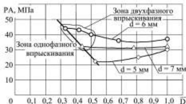
Рис. 4. Зависимость давления РА от диаметра поршня и параметра  $\bar{D}$ .
