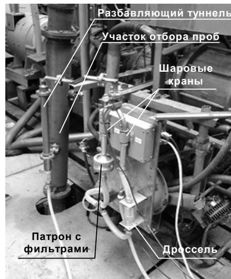
Рис. 2. Монтаж МКТ-2 на тормозном стенде дизеля СМД-23
