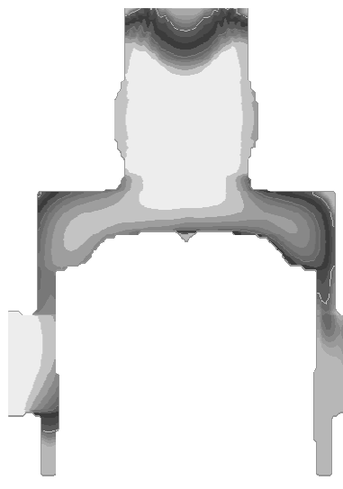
Рис. 5. Жидкая фаза в процессе кристаллизации
