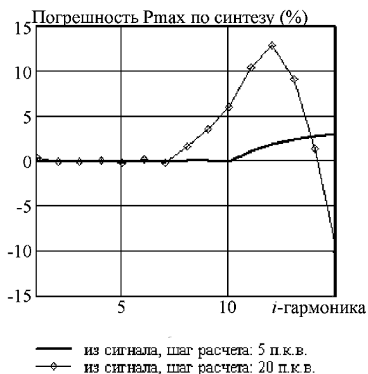
Рис.3. Погрешность максимального индикаторного давления по синтезу в зависимости от шага расчета и числа гармоник
