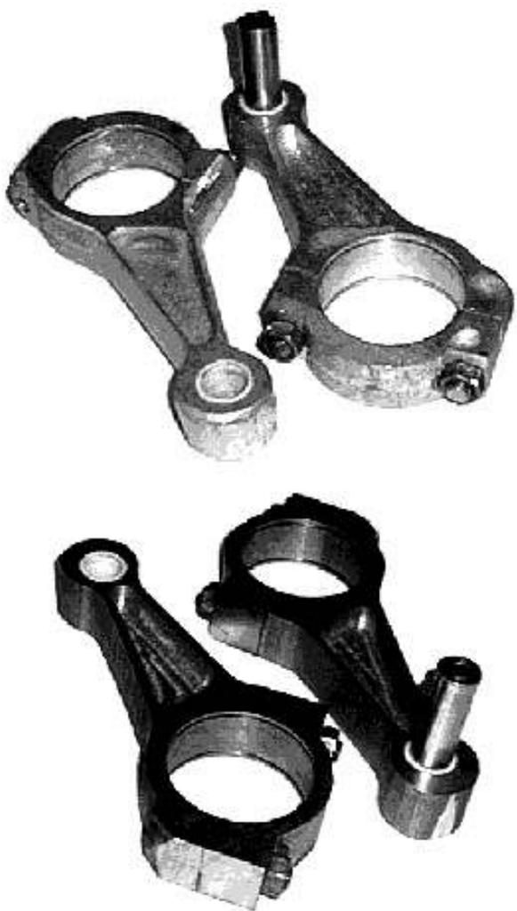
Рис. 2. Комплект шатунов двигателя ДС-КАДИ-1
