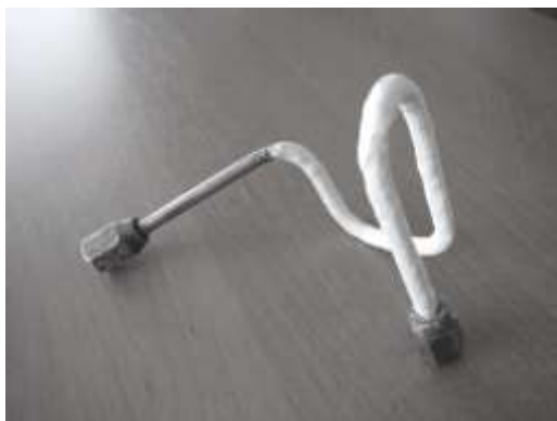
Рис. 3. Топливопровод, покрытый теплоизоляцией «Астратек металл»
