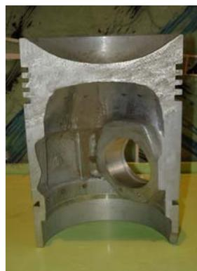
Рис. 4. Опытный поршень
