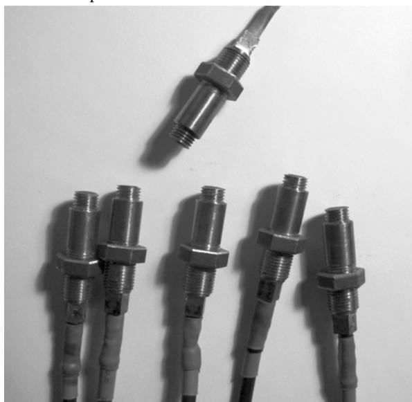
Рис. 3. Внешний вид вихретоковых датчиков
