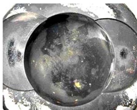
Рис. 1. Опытный поршень дизеля 4ЧН12/14 с поверхностным корундовым слоем
