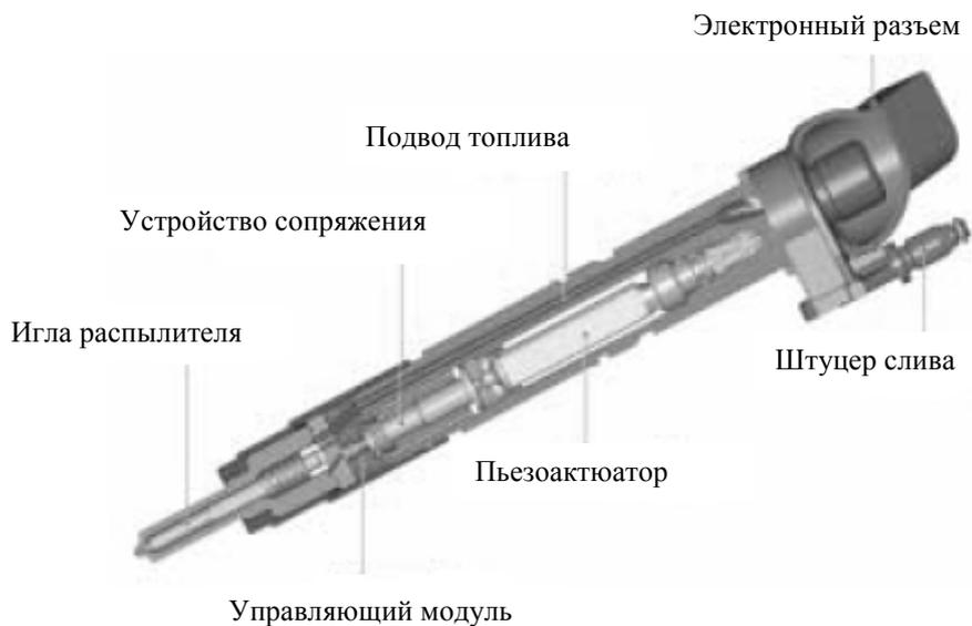
Рис. 2. Пьезоэлектрическая форсунка Robert Bosch третьего поколения
