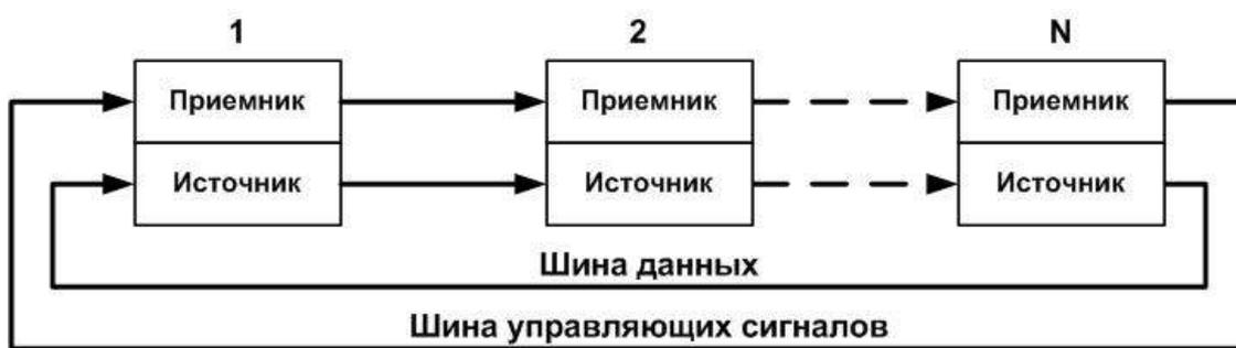
Рис. 3. Кольцевая структура интерфейса
