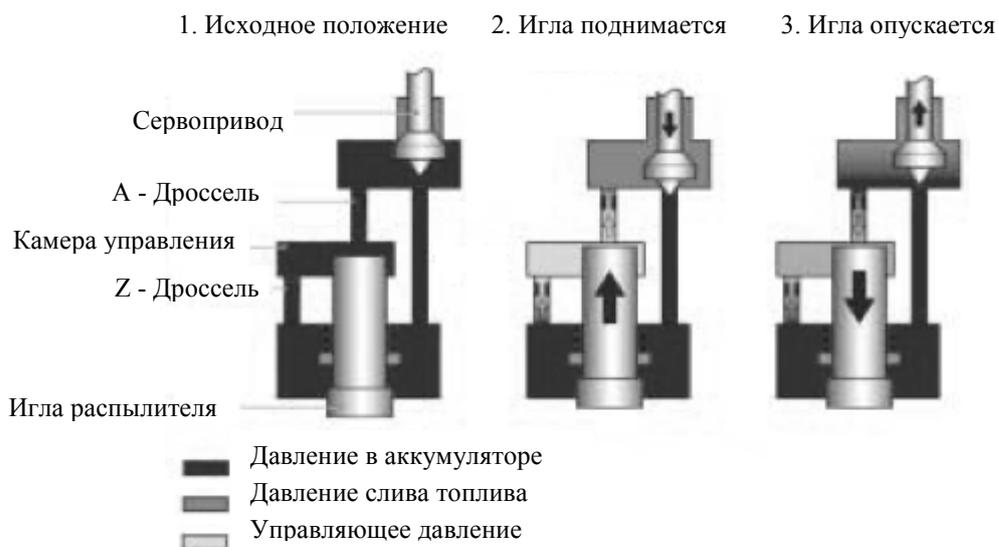
Рис. 3. Принцип работы форсунки CRI3 фирмы Robert Bosch
