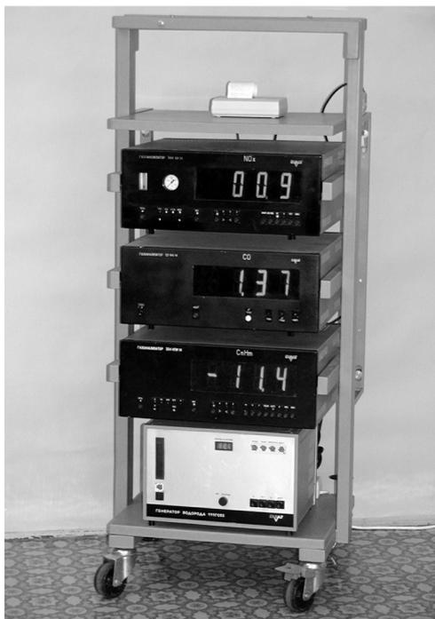
Рис.1. Газоаналитический комплекс с микропроцессорной системой
