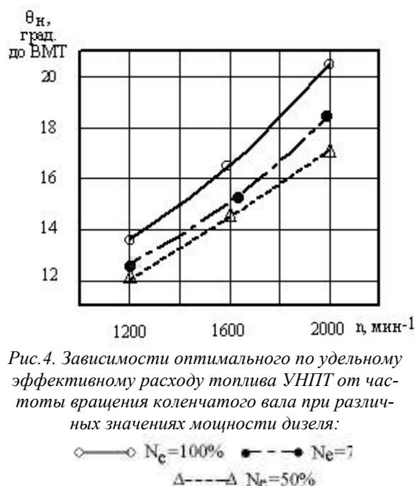
Рис.4. Зависимости оптимального по удельному эффективному расходу топлива УНПТ от частоты вращения коленчатого вала при различных значениях мощности дизеля:
