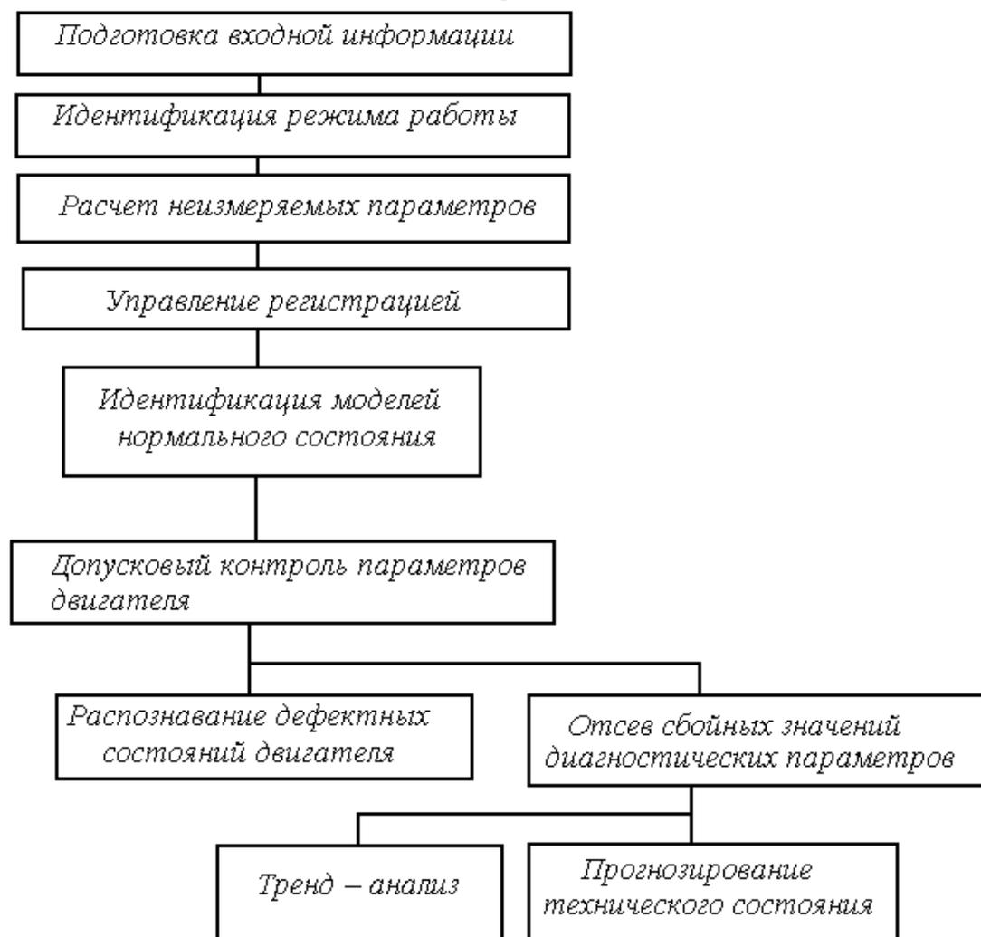
Рис.3. Иерархическая схема взаимодействия алгоритмов АСПД
