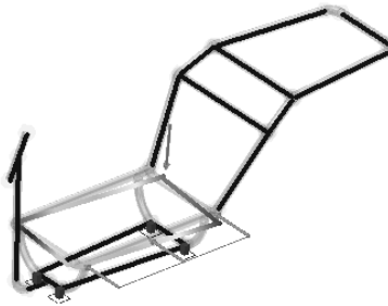
Рисунок 7. Первая конфигурация рамы – боковая нагрузка
