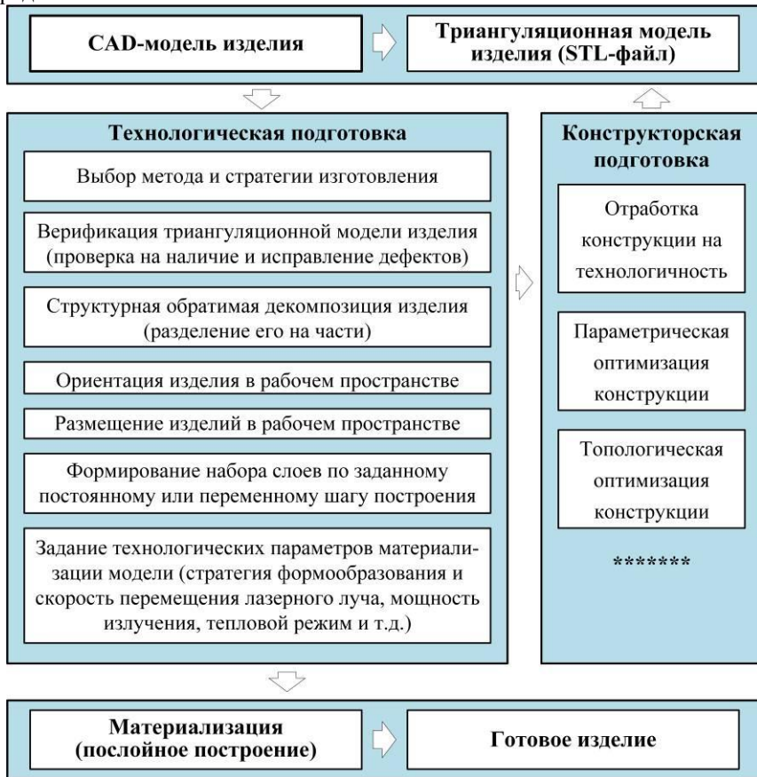
Рисунок 1 – Задачи технологической подготовки к материализации изделия аддитивными технологиями
