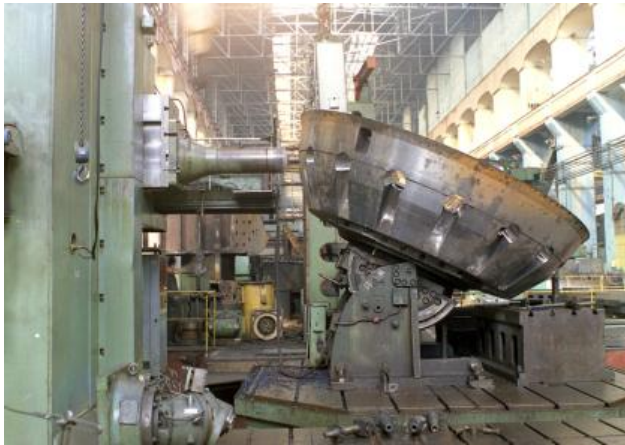
Рисунок 6 – Растачивание внутреннего кольца направляющего аппарата на станке фирмы Инноченти
