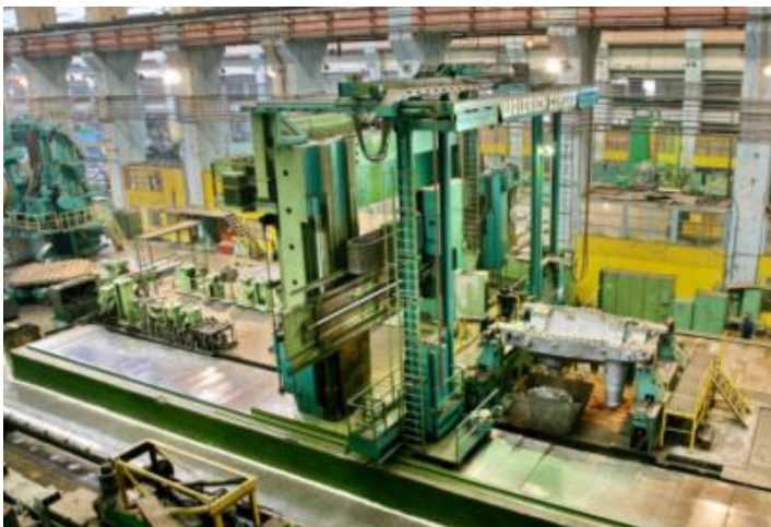
Рисунок 16 – Капитальный ремонт и модернизация специального продольно-обрабатывающего станка с ЧПУ модели NC-33Ф2
