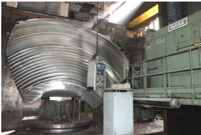
Рисунок 8 – Обработка лопасти рабочего колеса на фрезерно-расточном станке фирмы Инноченти
