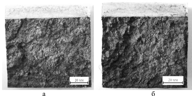
Рисунок 5 – Злами зразків із сталі ВНЛ-6 після термічної обробки: а – за режимом 5; б – за режимом 6
