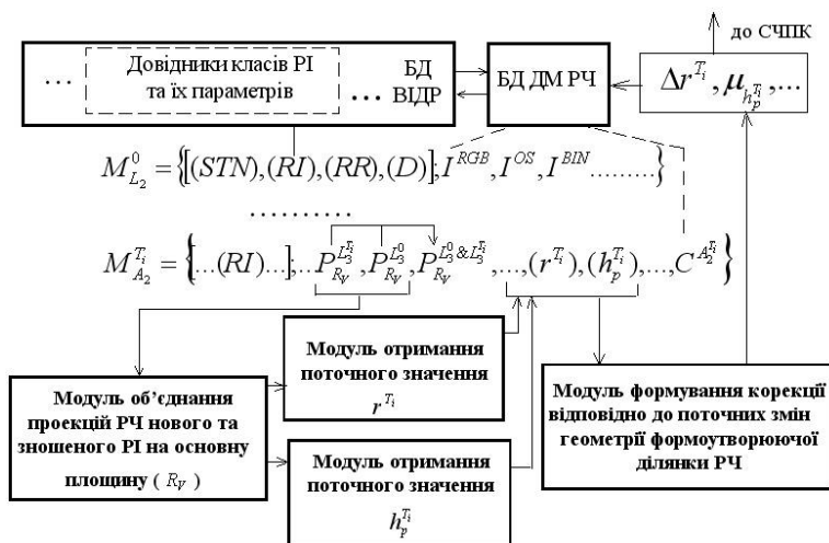
Рисунок 6 – Схематичне подання процесів оцінки поточних параметрів формуютьрочної ділянки різальної кромки, радіального зносу РІ та формування відповідних параметрів корекції для СЧПУ верстата
