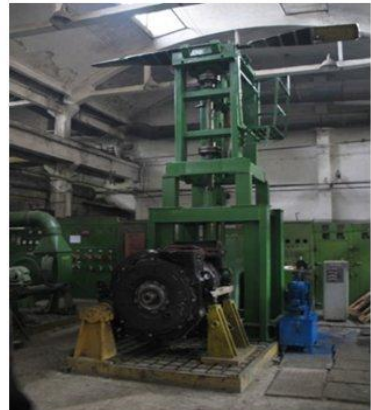
Рис. 4. Стенд динамических испытаний и фото стенда 1-электродвигатель постоянного тока, 2-конический редуктор, 3-цилиндрический редуктор, 4-шпиндель цилиндрического редуктора, 5-лопасть с гибкими элементами, 6-трос, 7-узел подшипников с корпусом, 8-шток, 9-поршень, 10-гидропневмоаккумулятор, 11-гидроцилиндр, 12-гидрораспределитель, 13-узел крепления троса, 14-штулка
