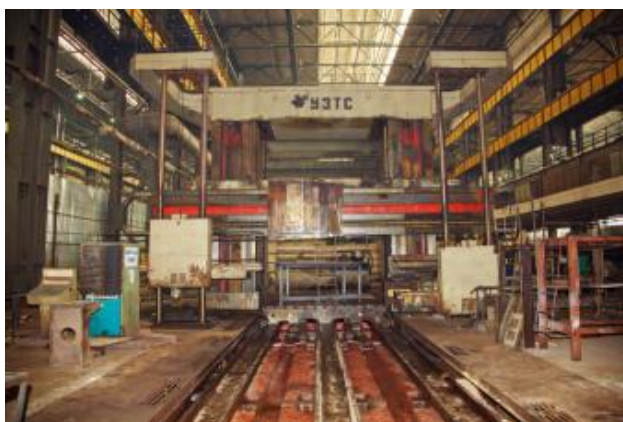
Рисунок 18 – Капитальный ремонт и модернизация продольно-фрезерного станка с ЧПУ модели 6640Ф2
