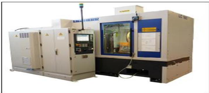
Рисунок 2 – Станок зубофрезерный модели
