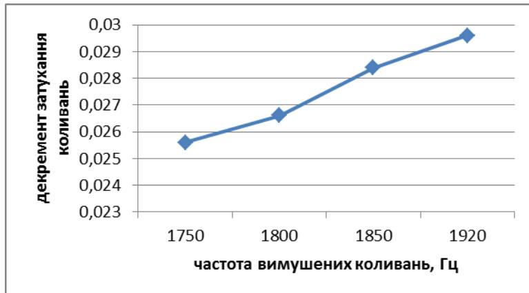
Рисунок 3 – Залежність декремента затухання коливань від частоти
