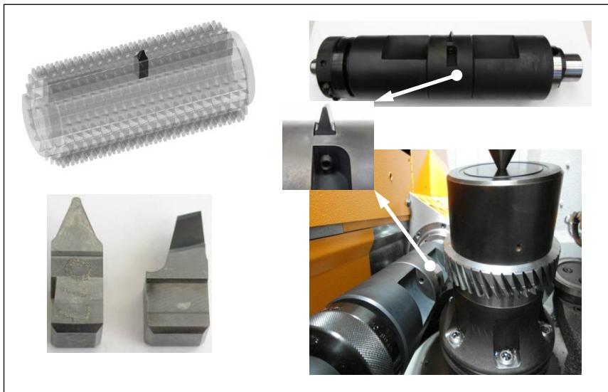
Рисунок 4 – Конструкция однозубой червячной фрезы
