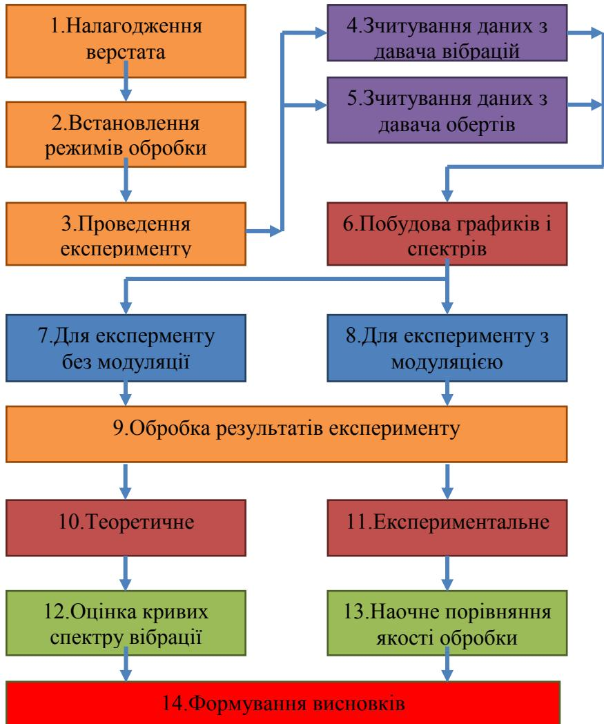
Рисунок 9 – Методика досліджень вібростійкості процесу точіння
