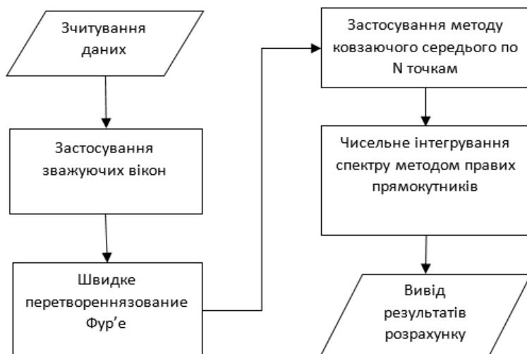
Рисунок 3 – Блок-схема обробки сигналу
