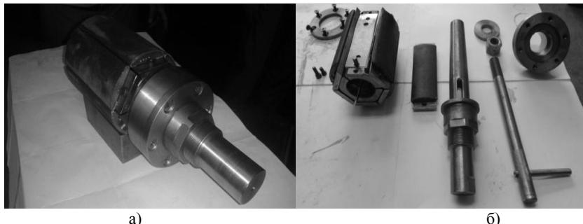
Рисунок 13 – Хонопритир: а – загальний вигляд; б – у розібраному вигляді
