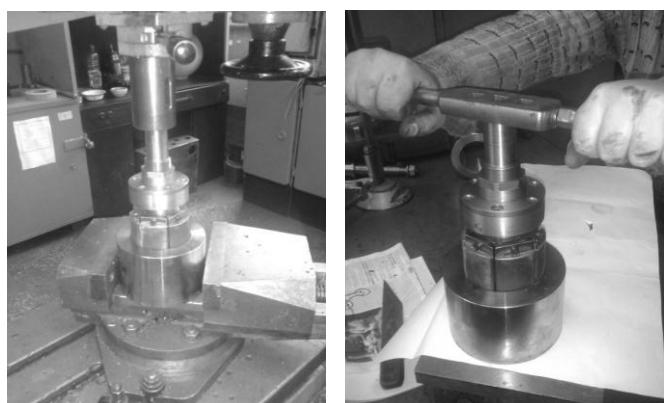
Рисунок 14 – Обробка хонопритиром втулки ротора на верстаті (а)
