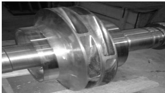
Рисунок 1 – Одноступінчастий ротор відцентрового насосу
