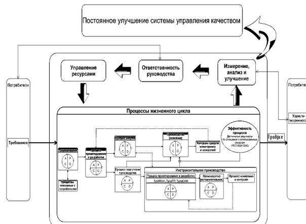
Рисунок 3 – Схема системы качества изготовления деталей инструментального производства
