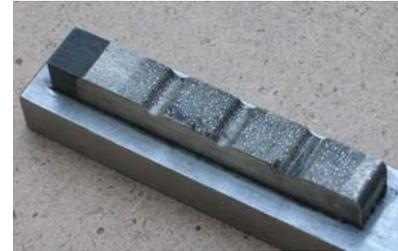
Рисунок 1 – Экспериментальный правящий брусок, изготовленный методом гальванопластики с осаждением толстого слоя никеля
