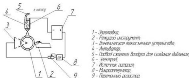
Рисунок – Принципиальная схема установки для комбинированной электрохимической обработки
