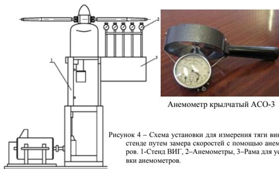
Рисунок 4 – Схема установки для измерения тяги винта на стенде путем замера скоростей с помощью анемометров. 1-Стенд ВИГ, 2-Анемометры, 3-Рама для установки анемометров.
