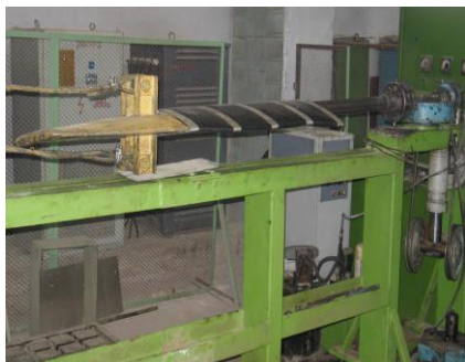
Рисунок 2 – Лопасть с гибкими элементами и нервюра
