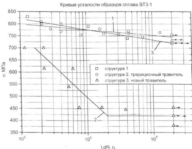
Рисунок 1 – Кривые усталости образцов из сплава ВТЗ-1
